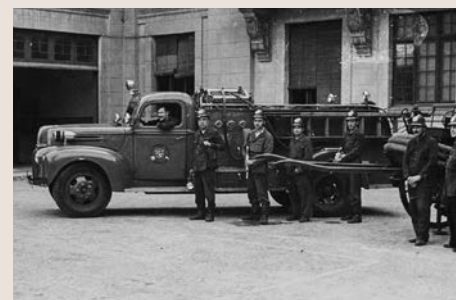
Bt7 1948. Adquisició de 1948. Excedent de material de guerra de l'exèrcit dels Estats Units d'Amèrica. Camió dissenyat especialment per lluitar contra incendis de combustible líquid als aeroports de campanya. ABB
