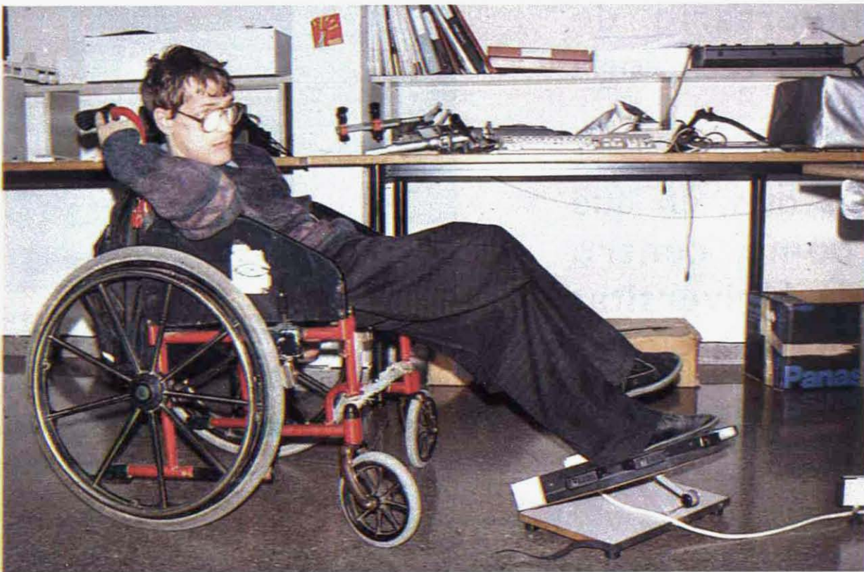
Un pedal con distintos pulsadores permite la comunicación a un discapacitado agudo en el centro Pont del Dragó
