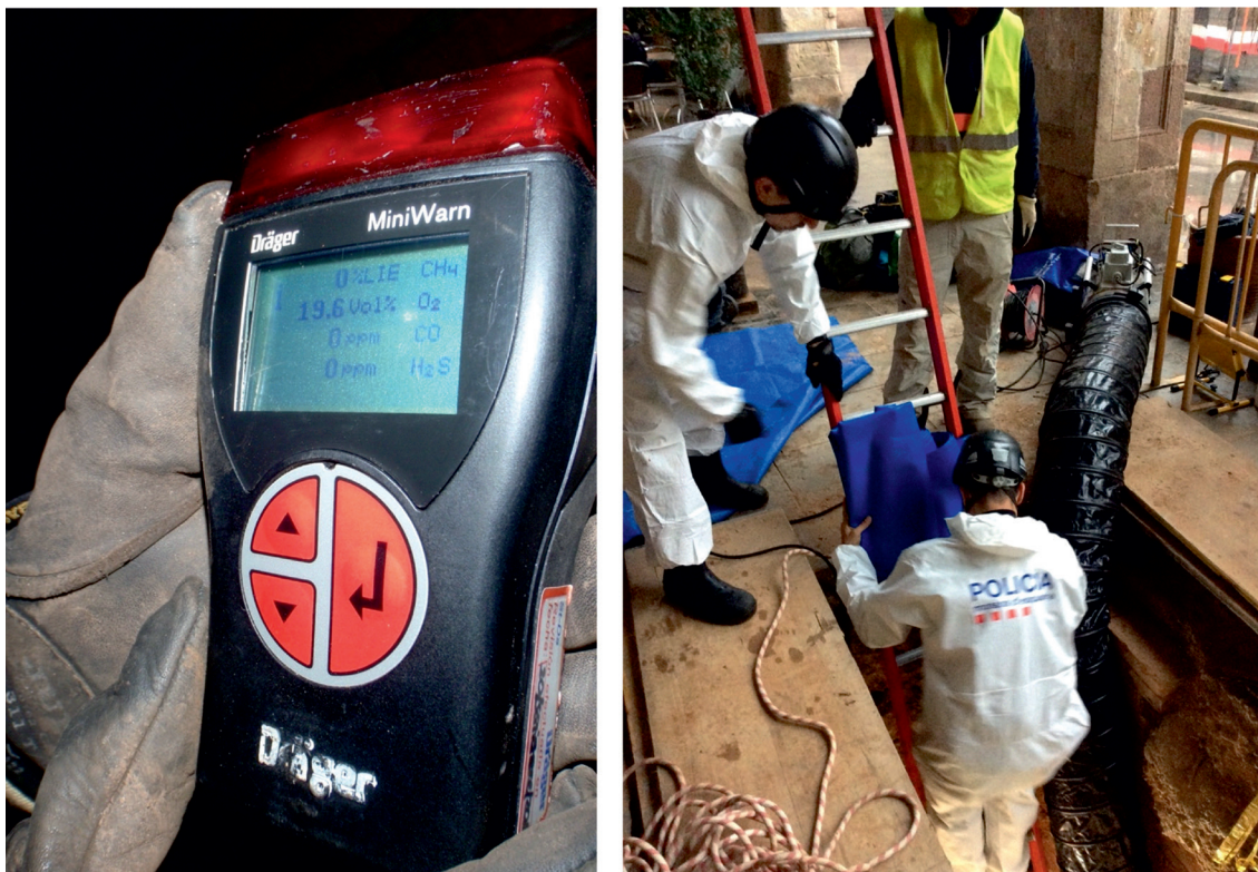
Figura 2 El detector de gasos i l'extractor són eines de gran utilitat en la inspecció dels espais confinats. [Fotografia: LL. Vivancos]
